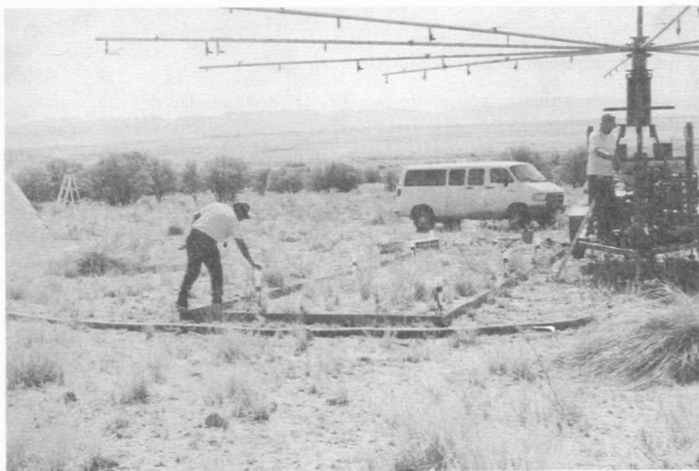
Colocación de pluviómetros para evaluar la variabilidad espacial de la precipitación.
