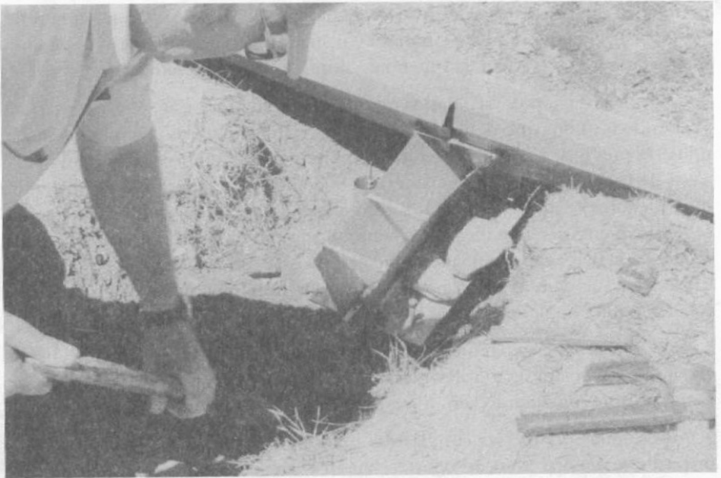
Colocación del medidor de flujo en el extremo inferior de la parcela.
